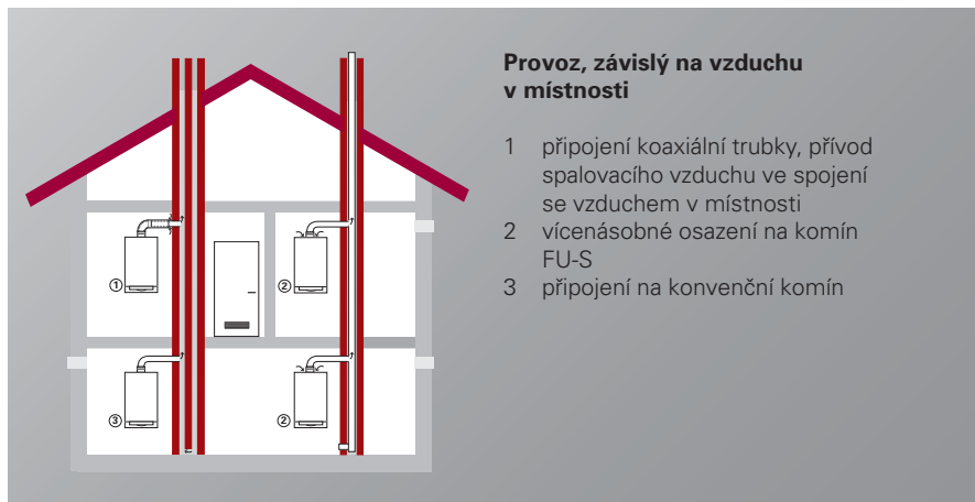
Obrázek 35: Spalinové systémy pro Vitodens 200-W a 300-W pro provoz závislý na vzduchu v místnosti
