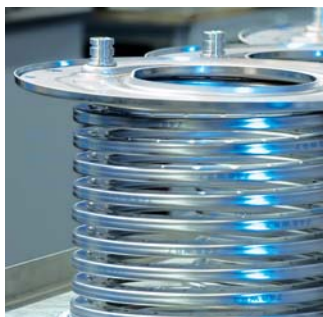
Výměník tepla Inox-Radial ve výrobě.
