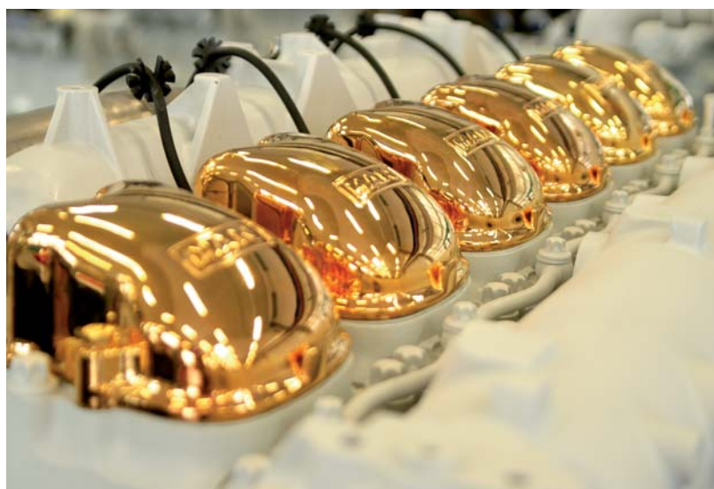
Srdce kogenerační jednotky: 6 válcový zážehový motor s provozem na plyn.
