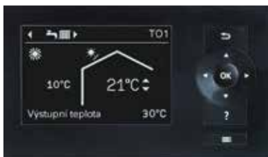
Regulace tepelného čerpadla Vitotronic 200.
