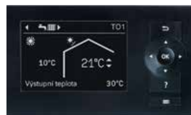
Obsluha Vitoventu 300-W přes regulaci tepelného čerpadla Vitotronic 200, typ WO1C.
