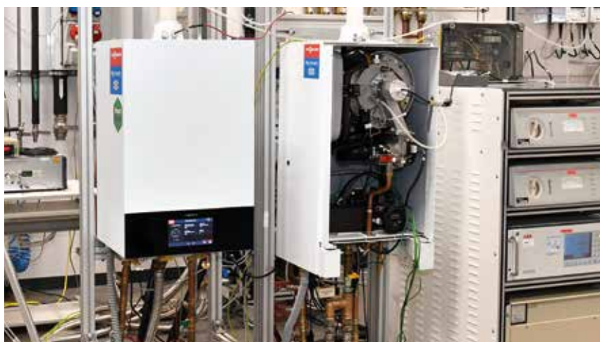
Ve středisku Viessmann Technikum se momentálně testují první prototypy na vhodnost pro 100 % příměsí vodíku.
